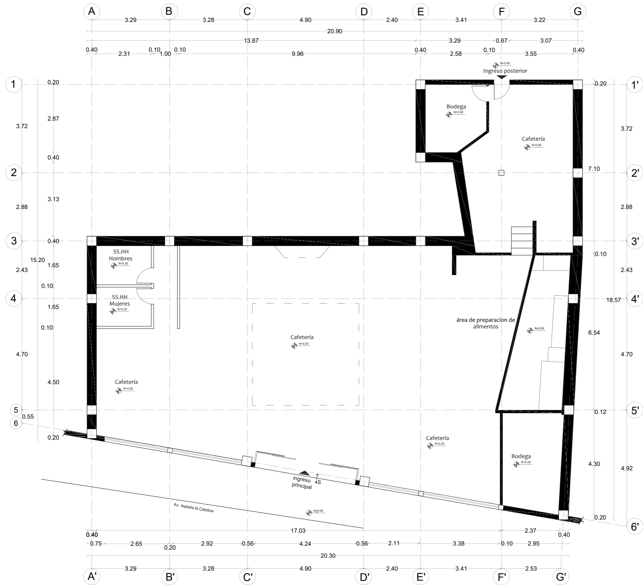
Plano Estado Actual Planta Baja ESC_1:100
