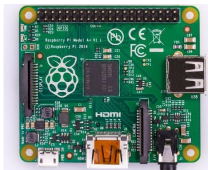
Figura 19 Placa Raspberry PI 1 de arquitectura ARM.
