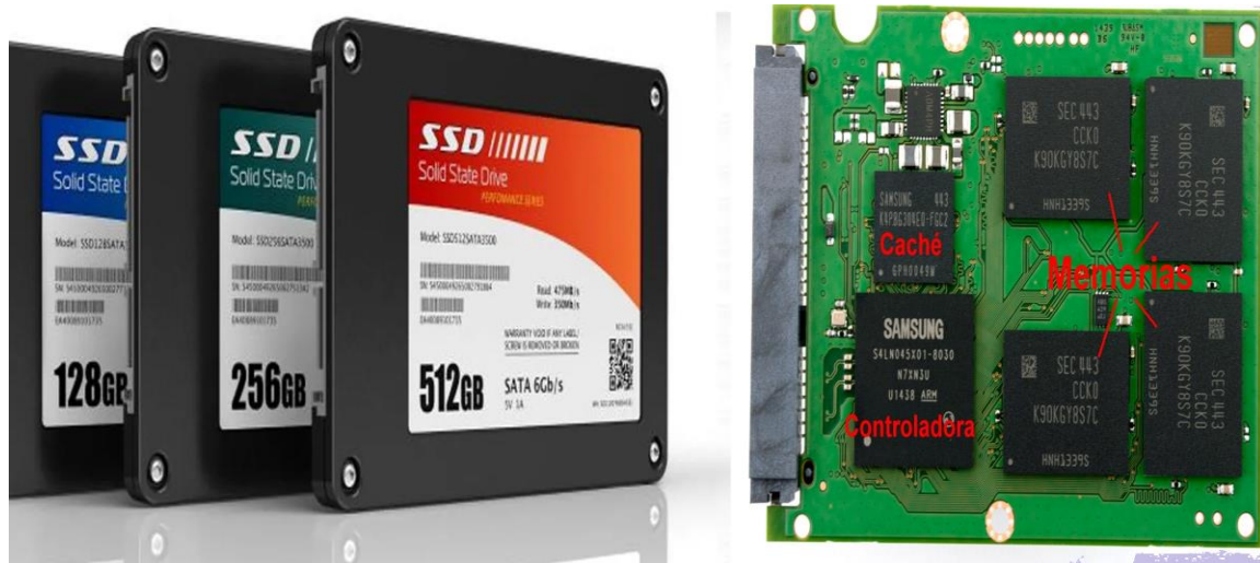
Figura 36 Unidades de estado sólido y sus partes.
