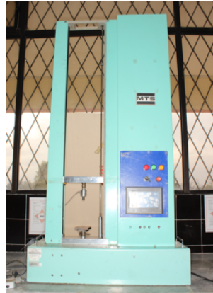
Figura 58. Máquina de Ensayos Universales MTS de la ESPE
