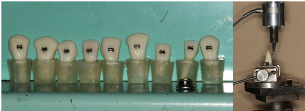
Figura 59. Muestras sometidas a la fuerza de cizallamiento
