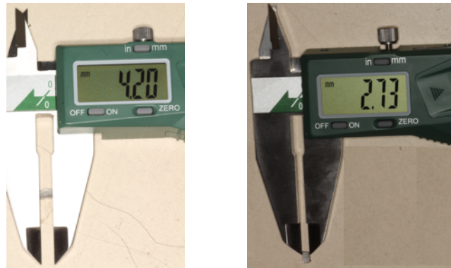
Figura 61. Medición de la base del bracket con calibrador electrónico
