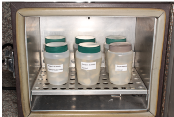
Figura 56. Incubación de las muestras a 37°C durante 24 horas
