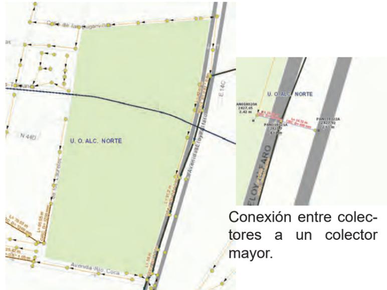
Conexión entre colectores a un colector mayor.
