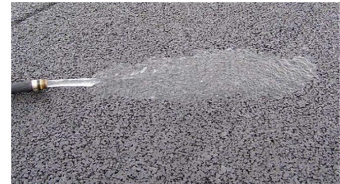
Figura 48. Hormigón Permeable
