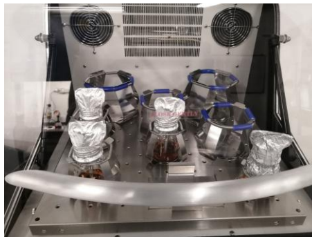
Figura 5. Frascos boeco de 100 mL con 30 mL de caldo BHI con caldo bacteriano en los que se introdujeron las pinzas mathieu. Cultivados en agitación permanente a 37°C durante 24 horas.
