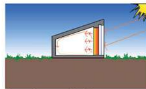
Muro de acumulación no ventilado
