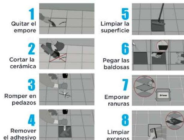
Figura 2: Proceso de remoción y colocación de baldosas cerámicas
