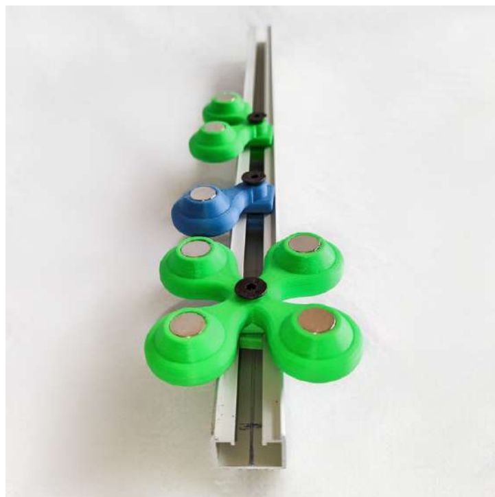
Figura 68. Variaciones de soportes instalados en perfil
