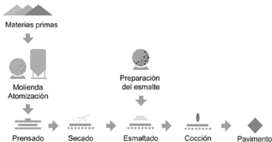
Figura 4: Proceso de la fabricación de baldosas cerámicas
