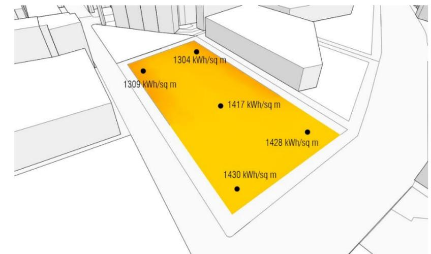
*Figura 96. Análisis de radiación solar en el terreno*
