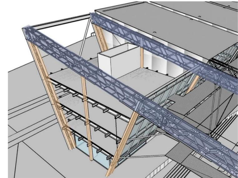
Figura 69. Diagrama de funcionamiento sistema estructural
