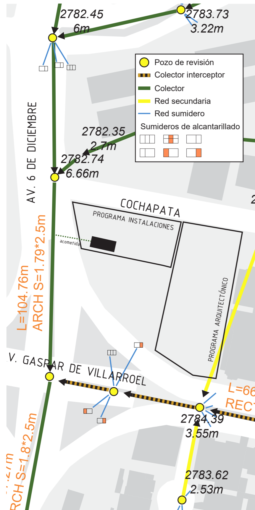
Figura 105. Conexión a red pública de alcantarillado
