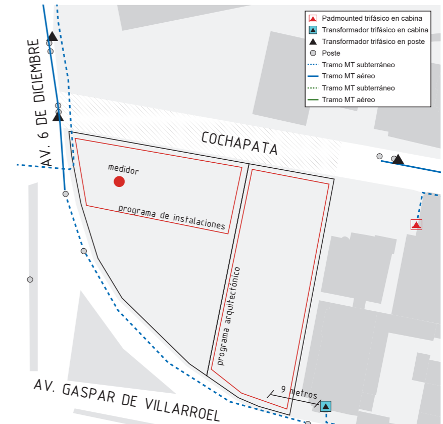
Figura 101. Red eléctrica en el lote
