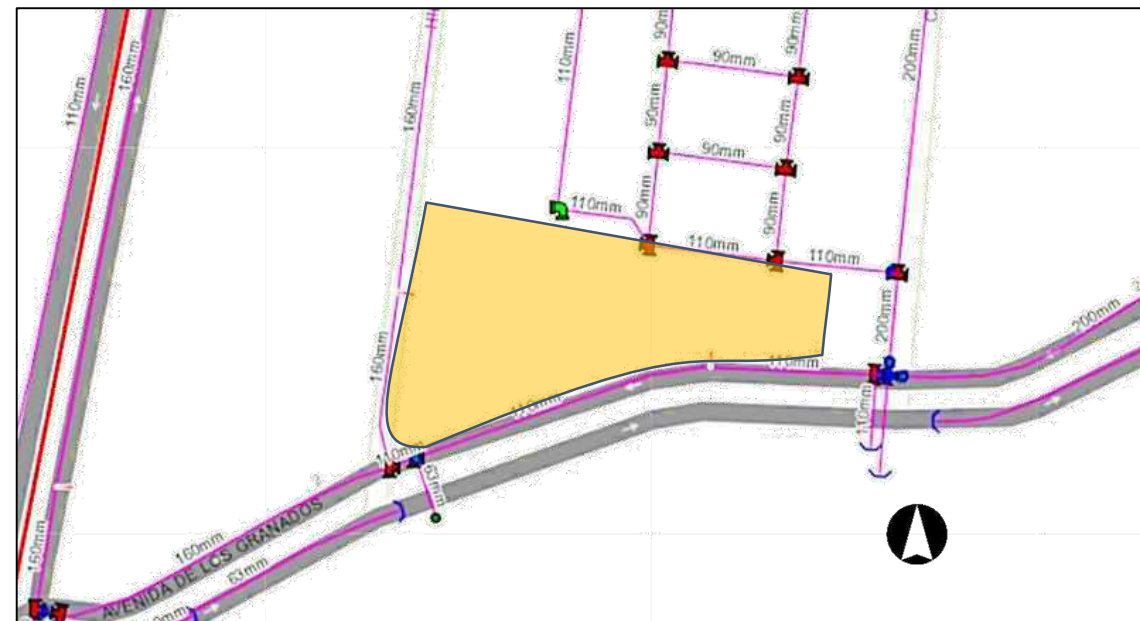
Figura 122. Abastecimiento de Agua potable
