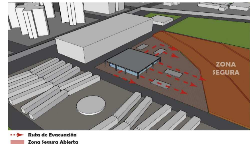
Figura 172. Ruta de evacuación exterior.
