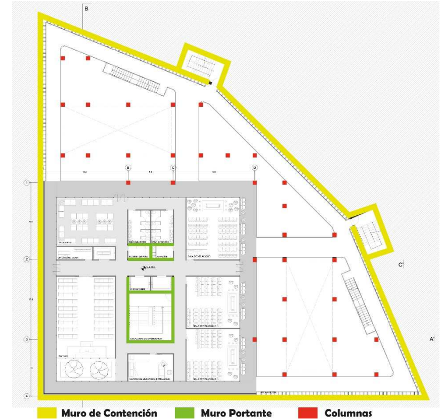
Figura 182. Definición de la estructura
