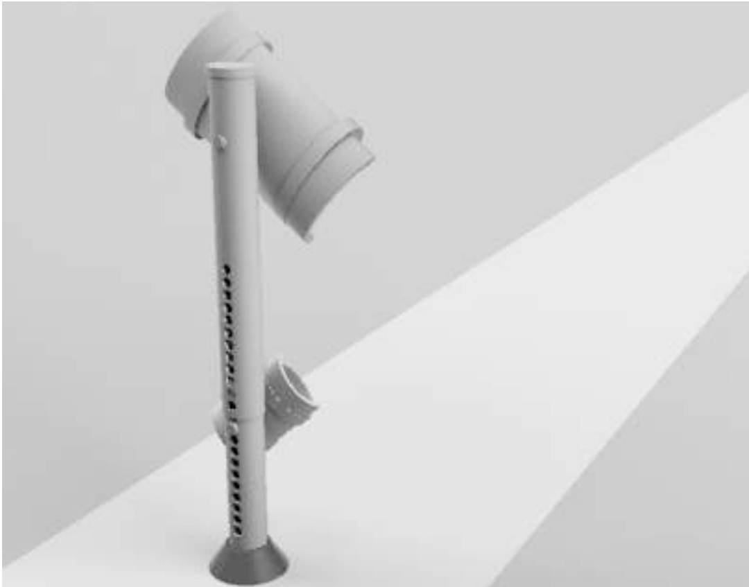
Figura 35. Modelado 3D del modelo 2, se visualiza las partes, además de la ajustabilidad y la forma en que las placas de la pierna se unen al eje central.
