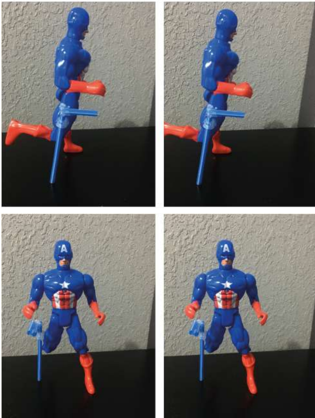
Figura 20. Este prototipo rápido sirvió para saber que siempre se necesita dos punto de sujeción para la extremidad ya que esto da descanso a la misma.
