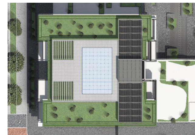
Figura 170. Ubicación de paneles solares. 50 paneles monocristalinos.
