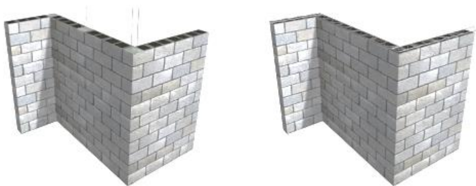
Figura 55. Mampostería de bloque.
