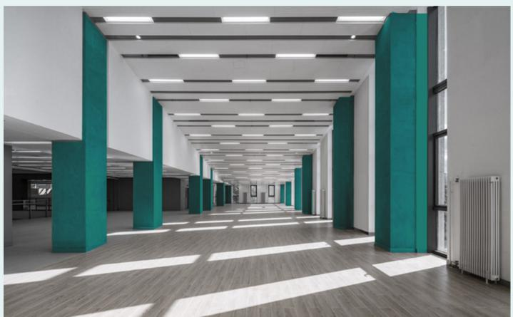
El edificio cuenta con un sistema estructural a base de pórticos de hormigón armado. Las columnas son de un tamaño considerable ya que se necesita un buen flujo de personas dentro de este.
