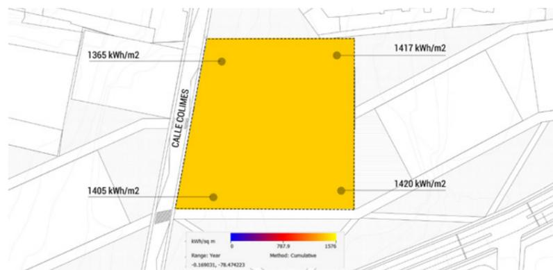
El cuanto al lote, el área con mayor radiación solar se localiza en la zona NO, con un valor de 1420 kWh/m2. Por otro lado, la menor incidencia solar se identifica en la zona SE del lote con un valor de 1365 kWh/m2. Así observamos que en todo el lote la radiación es similar. Este rango de radiación es muy alta por lo que al plantear el proyecto se deberá incluir estrategias que reduzcan la radiación en las zonas más afectadas.
