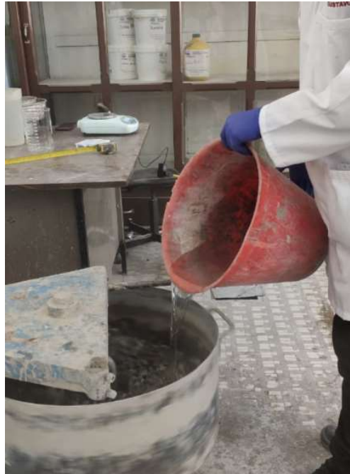
Figura12. Proceso de mezcla de los agregados, agua y lodo
