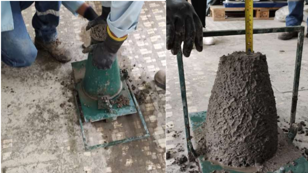
Figura 13. Determinación del asentamiento de las mezclas
