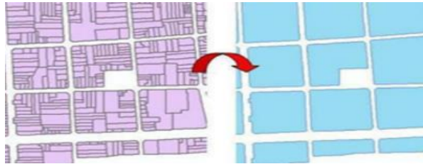
Figura 4. Ejemplo de simplificación del número de edificios
