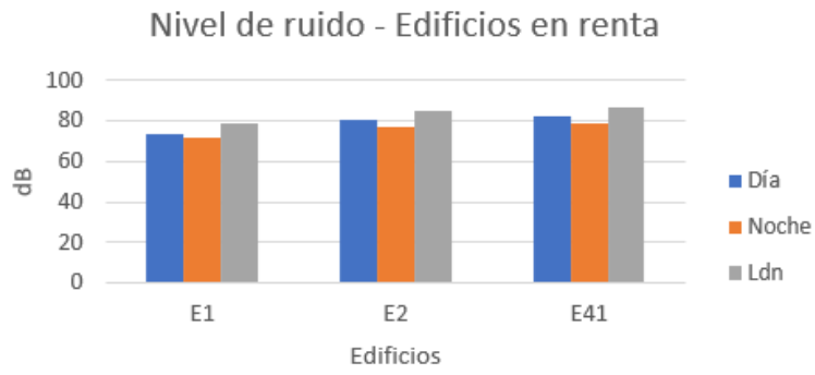
Figura 7. Nivel de ruido en edificios en renta.
