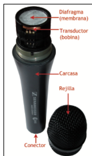
Figura 1. Estructura micrófono (García, 2013).
