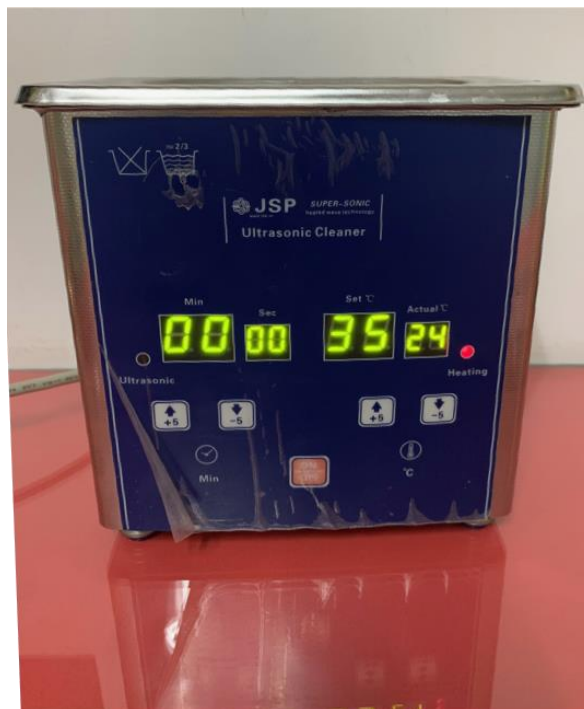
Figura 9 Ultrasonido Cleaner (JSP). Indica inicio de precalentamiento hasta llegar a una temperatura de 37°. La que se colocará las probetas durante 24 horas.
