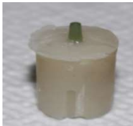
Figura 6. Cilindro de resina con el poste en medio.
