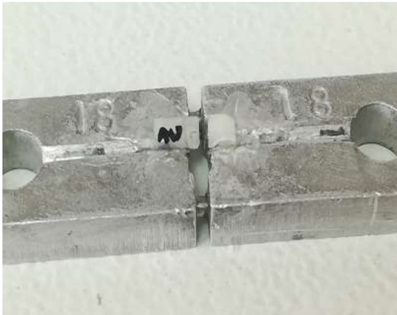
Figura 14. Fractura de la Viga
