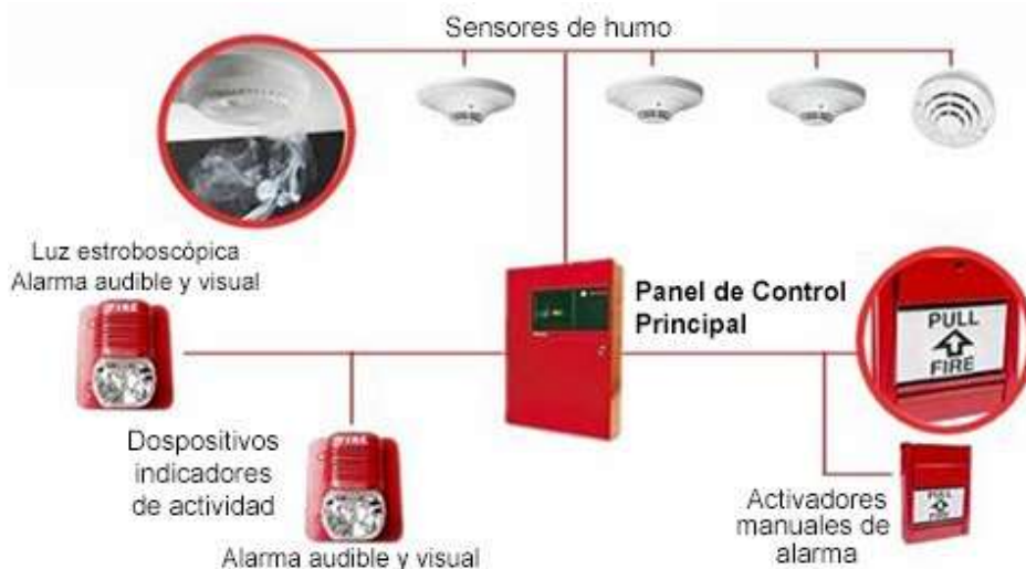
Figura 59. Funcionamiento de alarma contra incendios.
