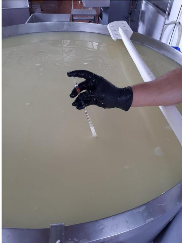
*Figura 77. Toma de muestra del suero para realizar análisis de pH.*
