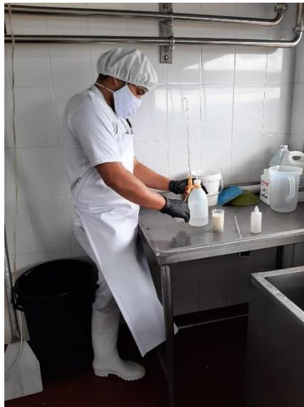
*Figura 74. Segundo análisis de pH de la leche, muestra tomada después de pasteurizar*
