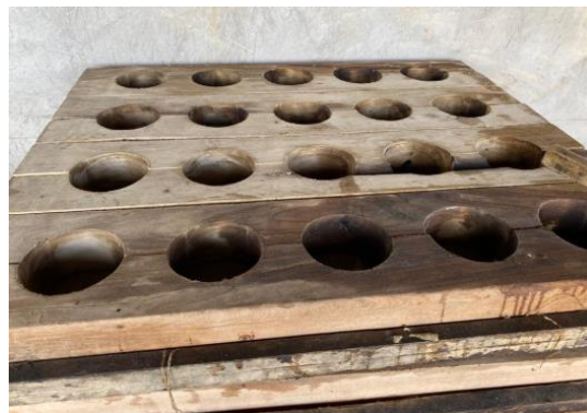
Figura 39. Molde de Panela en Maitos.
