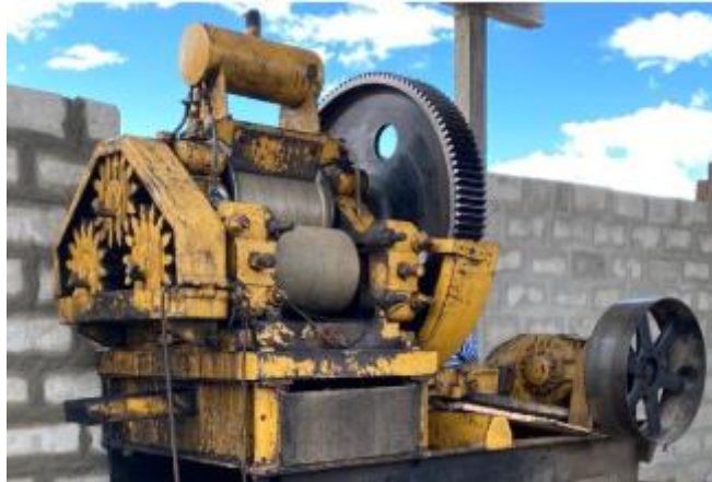
Figura 34. Trapiche numero 4,5 ocupado en la extracción del jugo de caña de la empresa Costa Rica.
