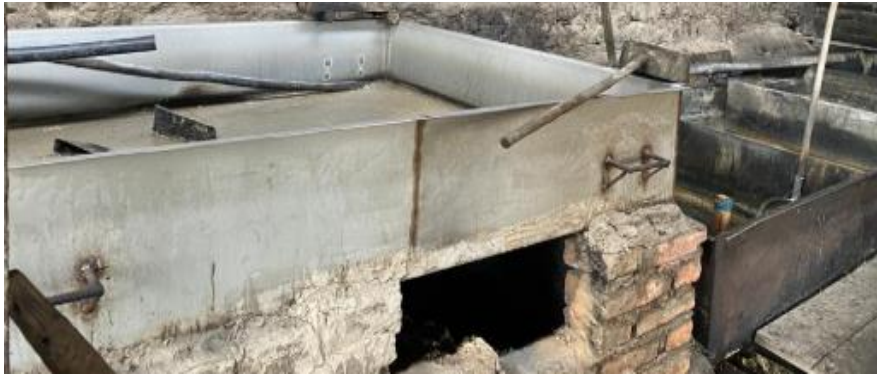
Figura 36. Pailas de transformación de jugo de caña a miel cristalizada.
