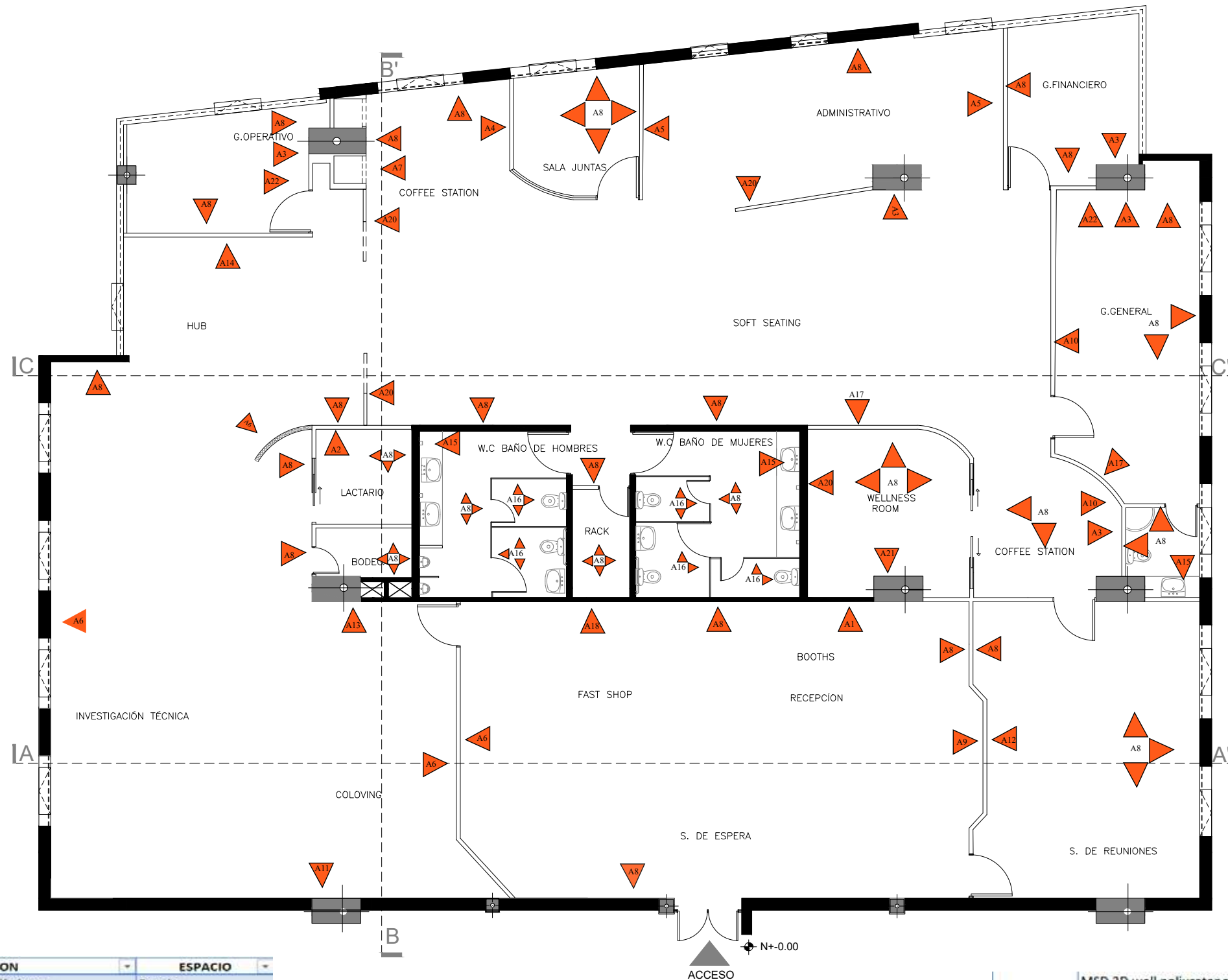
Planta Revestimientos de Paredes Esc: 1:125
