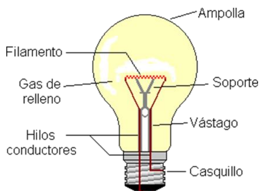
Figura 76. Partes de una bobilla.
