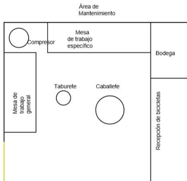
Figura 55. Planos distribución actual del taller de mantenimiento
