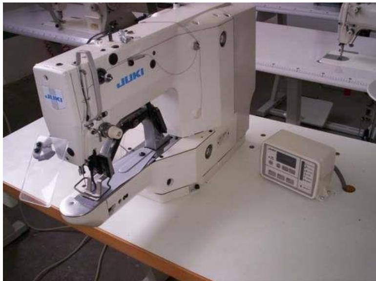
*Figura 22. Máquina Ojaladora Botonera*
