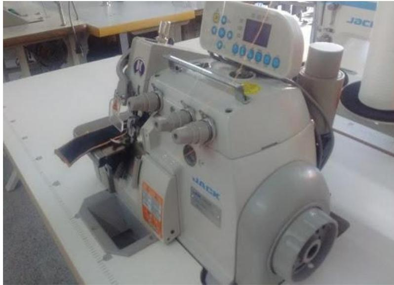
*Figura 19.* Máquina Overlock de 3 hilos
