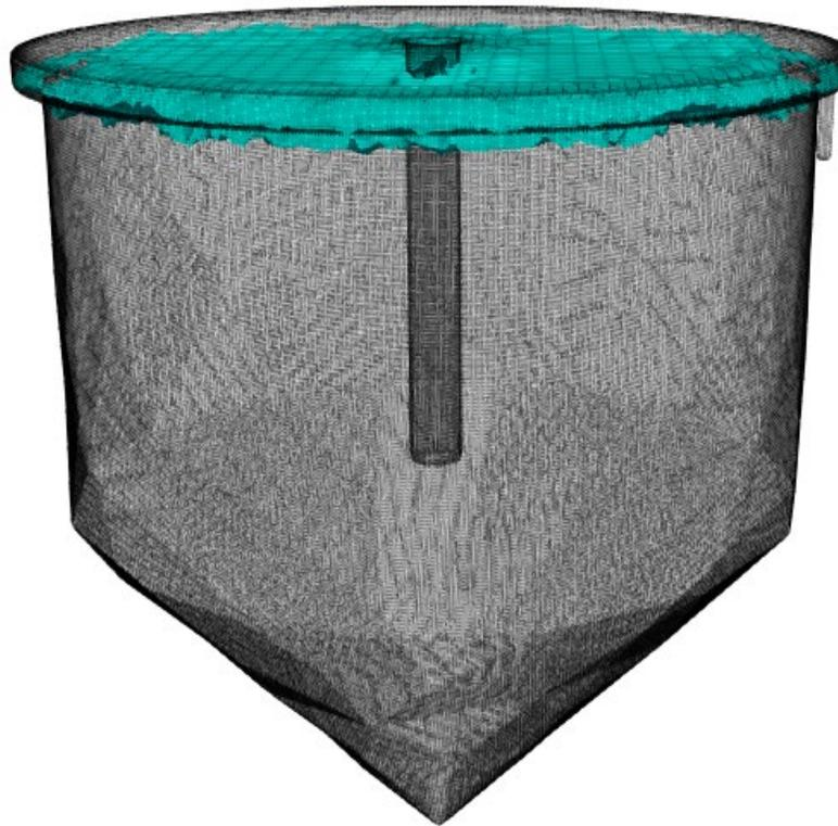
*Figura 19.* Vista lateral del contorno de nivel de agua en el clarificador secundario
