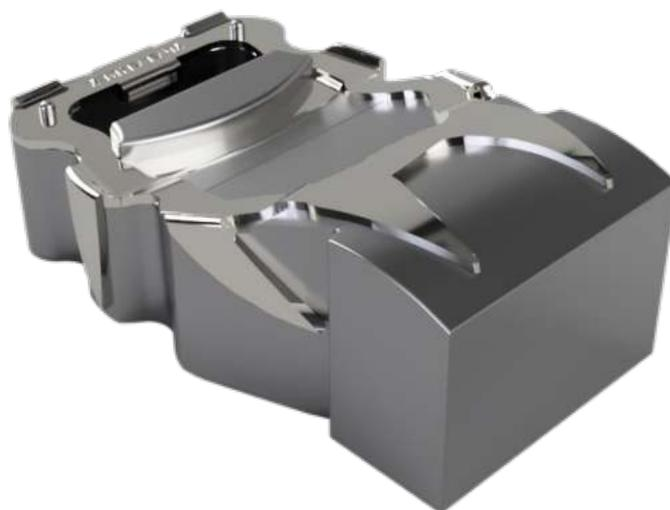
*Figura 134.* Estructura frontal del crampón sobre el molde macho.
