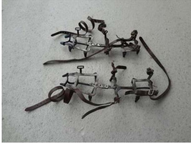
*Figura 35.* Crampón regulable con barra perforada.
