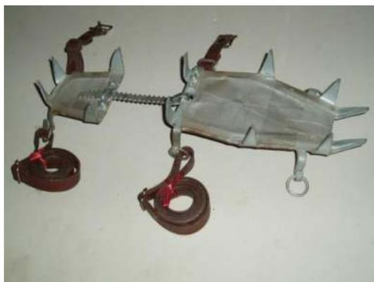
*Figura 32.* Crampon ajustable con barras dentadas.
