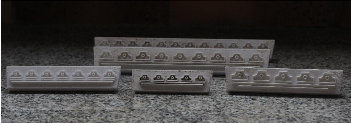
Figura 63. Impresión 3D del sistema de grabado.
