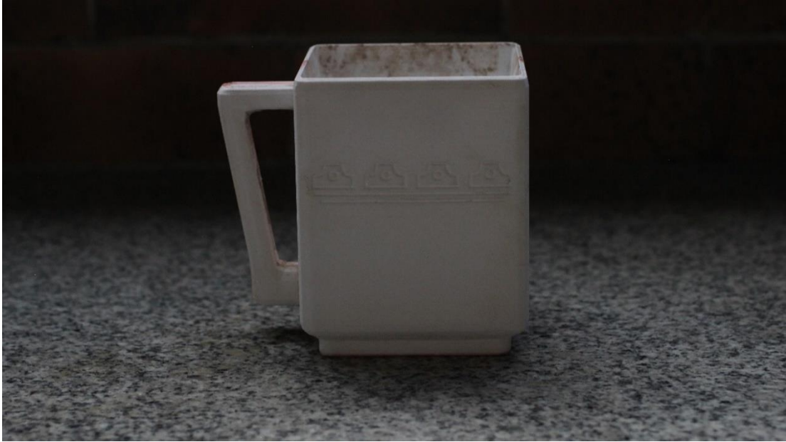
Figura 65. Impresión 3D del jarro para elaboración del molde.
