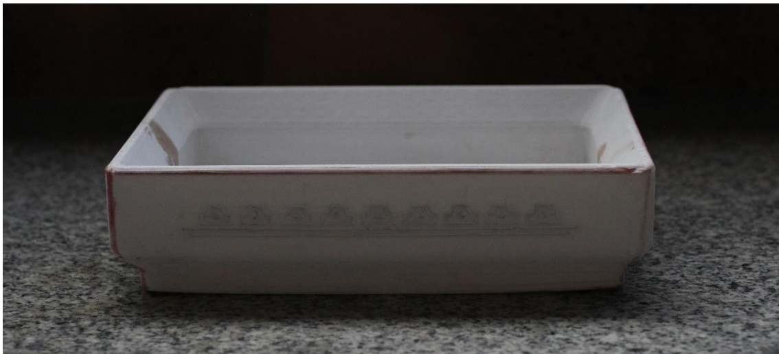
Figura 64. Impresión 3D de fuente para elaboración de moldes.
