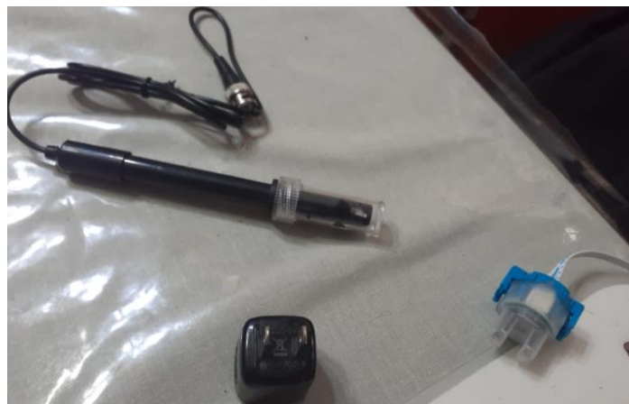
Figura 30. Sensores de pH, turbidez y fuente de alimentación
