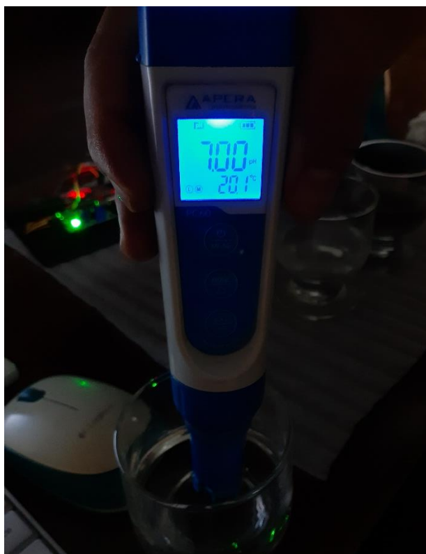
Figura 74. Medición agua potable medidor PC60.
