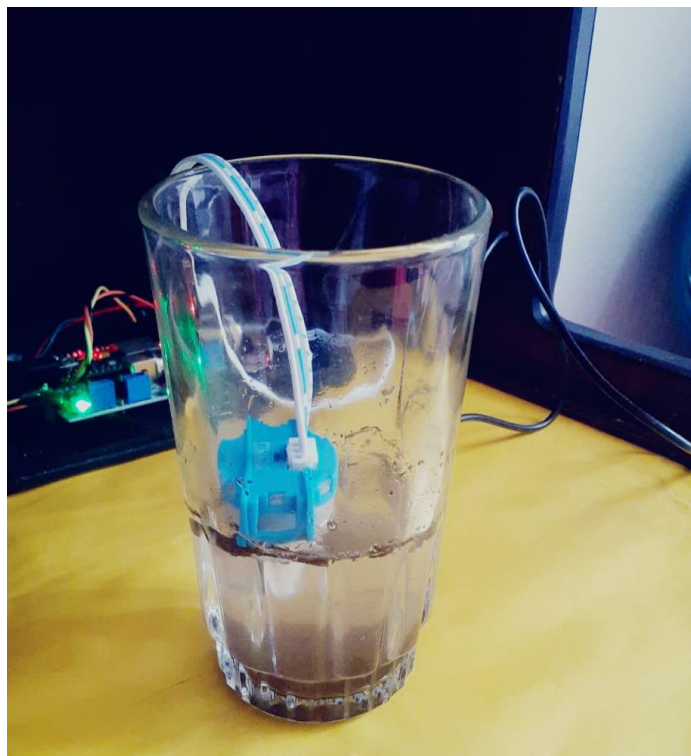
Figura 81. Sensor del prototipo en agua para desinfección
