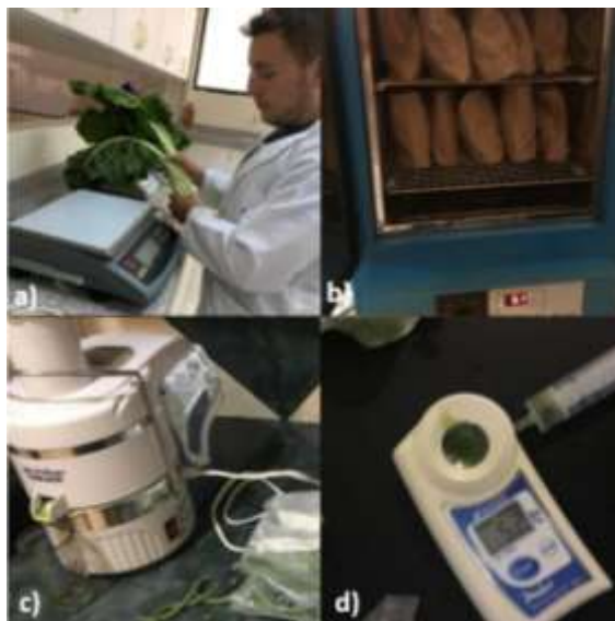
Figura 6: Medición de variables destructivas: a) Medición peso seco b) Secado de muestras para obtención de peso seco c) Extracción de jugo. d) Medición de azúcar en refractómetro
