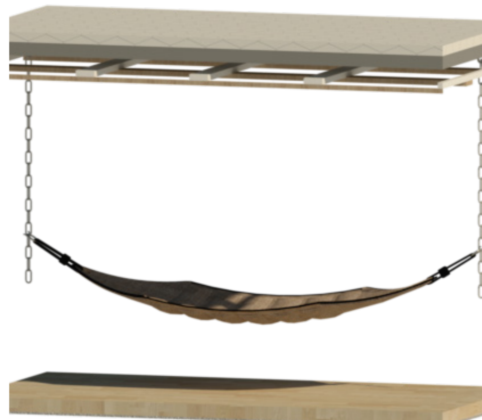
D1 Montaje de Hamaca a Losa ESC — 1:5
