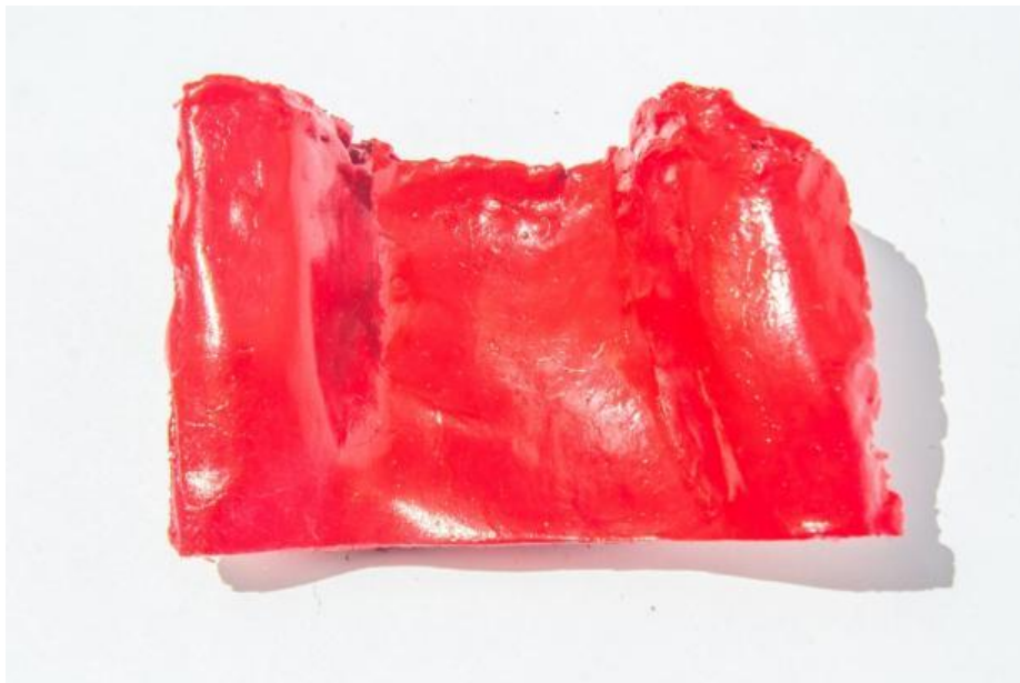
Figura 54 Segunda experimentación de aplicado pintura automovilística, pieza masillada y lijada.
