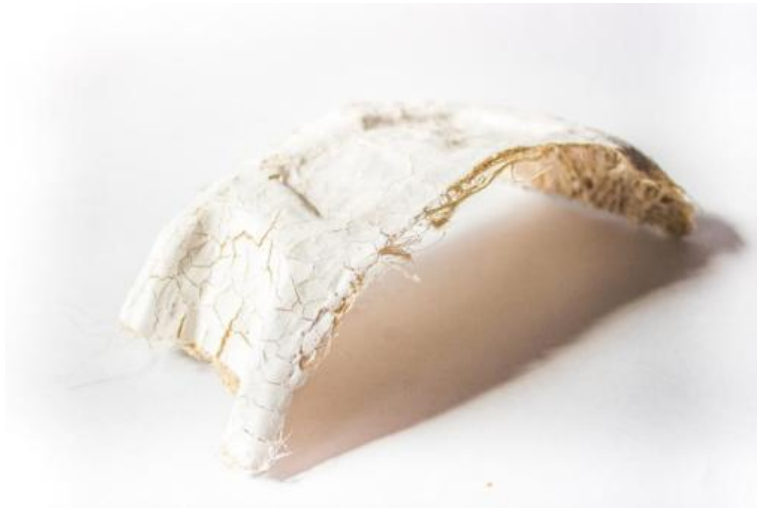
Figura 47 Resultado experimentación segundo proceso productivo de bioresina y mat de fibras vegetales en molde de motopieza seca.
