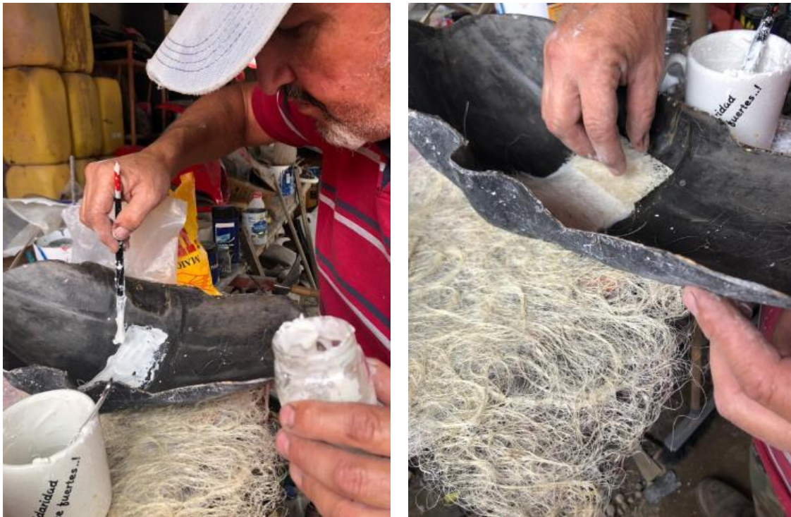
Figura 80 Osito, el experto, validando el biomaterial, tras replicar el proceso productivo de una motoparte con el biomaterial.
