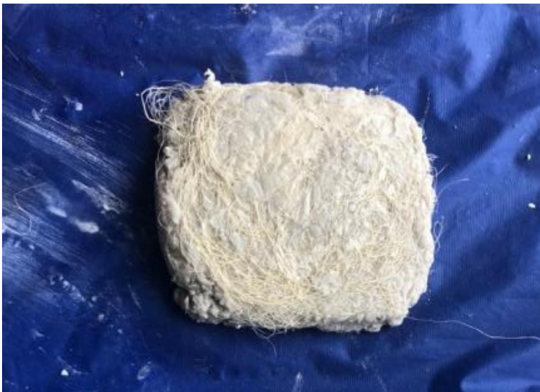
Figura 40 Experimentación de encolados naturales con fibras de cabuya con yeso y cera
