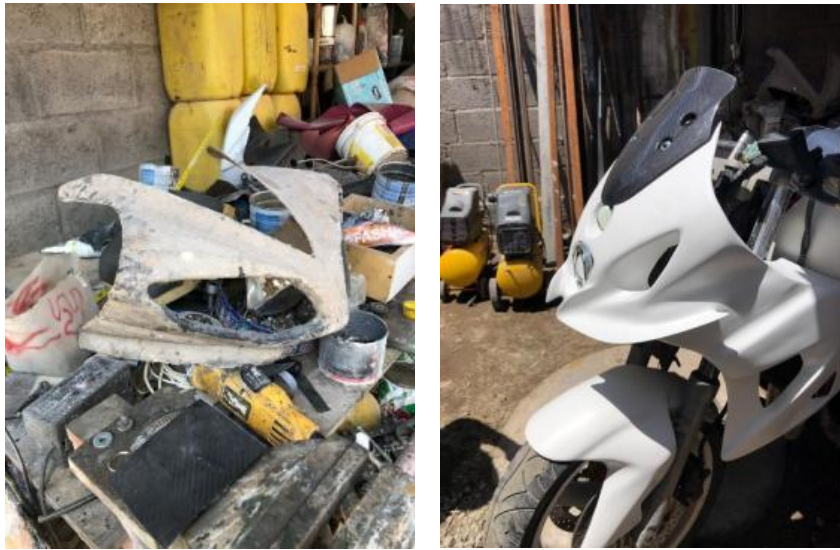
Figura 25 Molde de motopieza y Pieza acabada y montada. Diseños exclusivos de Ramiro Trujillo dueño de TRUMAN moto tuning
