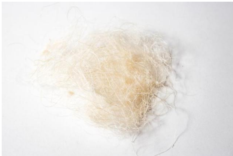
Figura 31 Resultado de tratamiento de fibras de cabuya impermeabilizadas con cera
