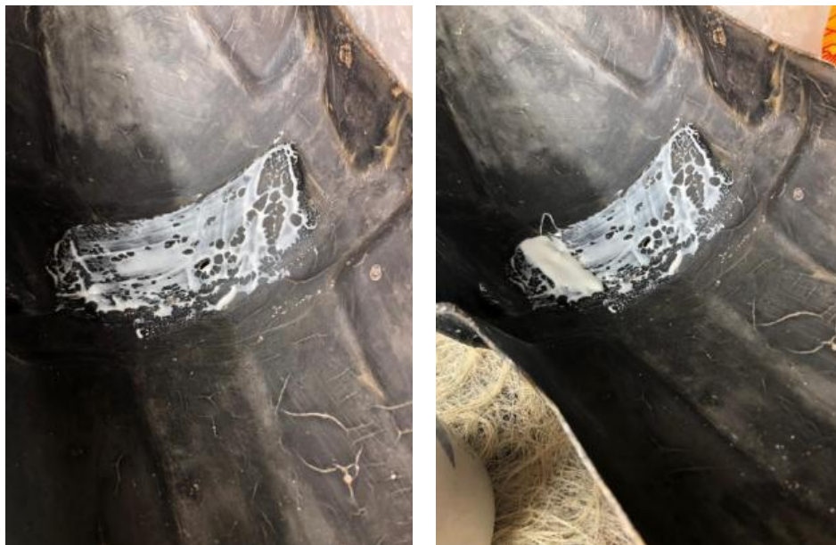
Figura 79 Validación del biomaterial con experto de fibra de vidrio, antes y después de alterar la composición de la primera capa de bioresina
