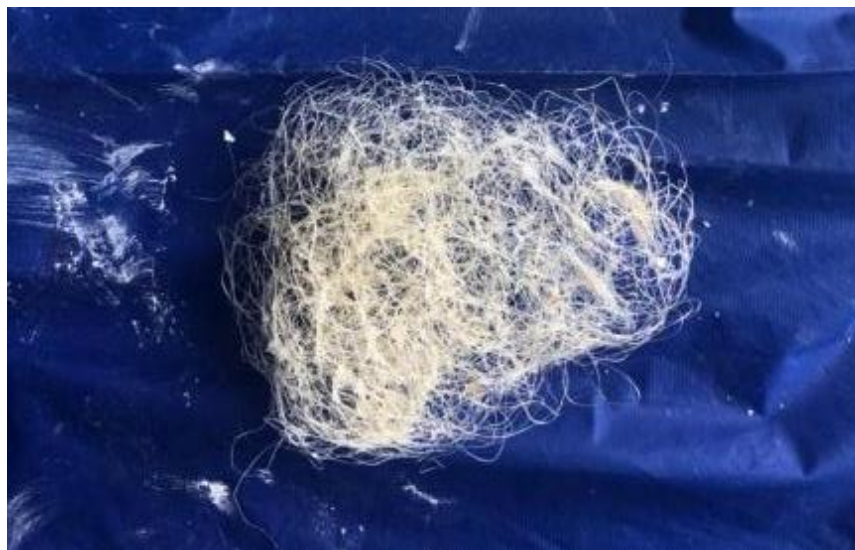
Figura 30 Experimentación de tratamiento de fibras de cabuya impermeabilizada con cera
