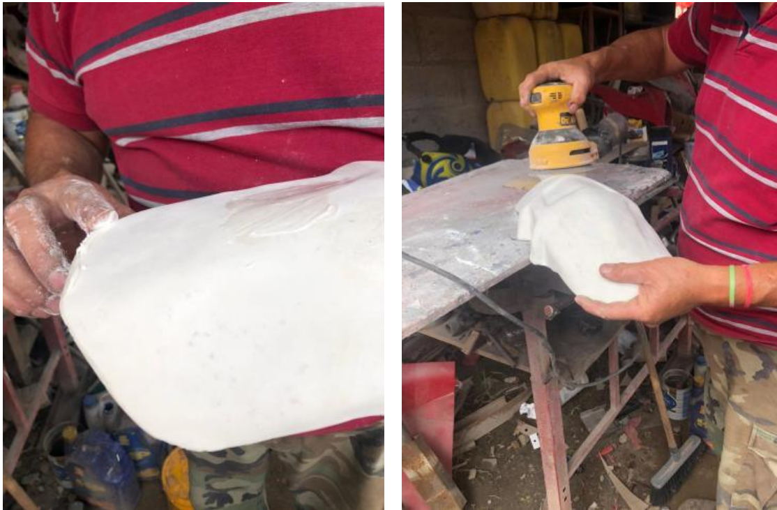
Figura 65 últimos toques de biomasilla previos a la lijada mecánica y previos a tener un acabado final más liso y resistente
