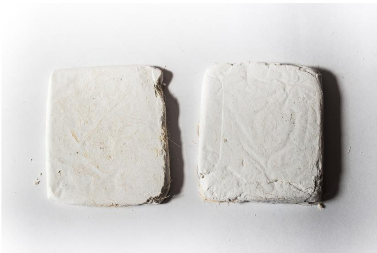
Figura 33 Resultado experimentación de encolados naturales con fibras de cabuya con yeso
