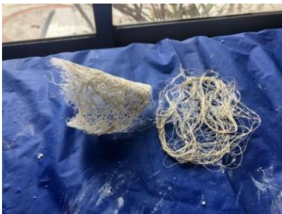
Figura 27 Experimentación de tratamiento de fibras de cabuya con encolado de goma blanca
