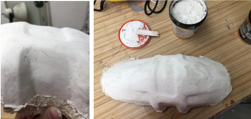
Figura 61 Proceso de acabados de la pieza final. Masillado
