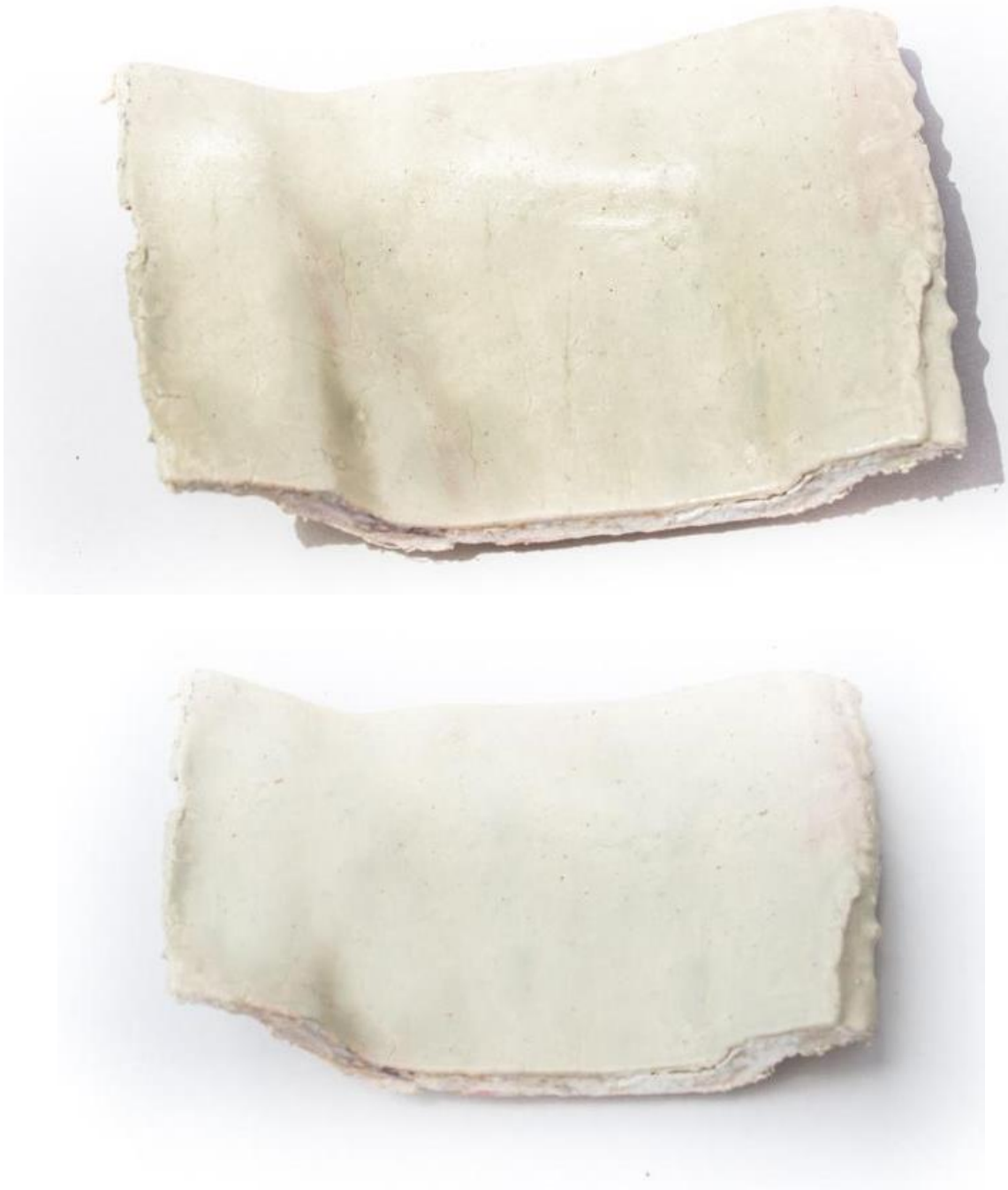
Figura 53 primera experimentación de aplicado base de pintura automovilística, pieza masillada y lijada
