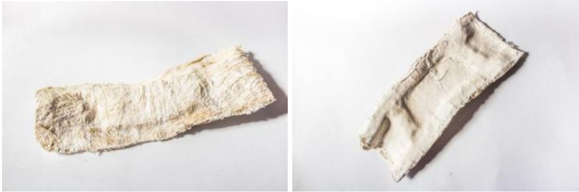
Figura 45 Resultado experimentación proceso productivo de bioresina y mat de fibras vegetales en molde de motopieza seca diferentes perspectivas
