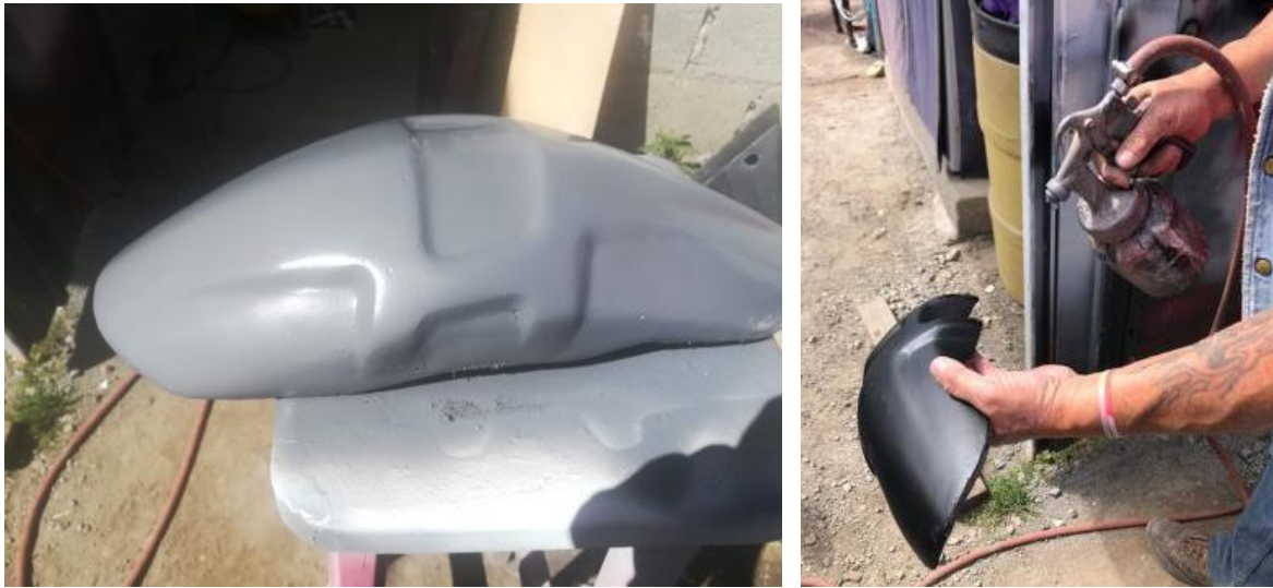
Figura 66 prototipo fondeado y pintado con compresor
