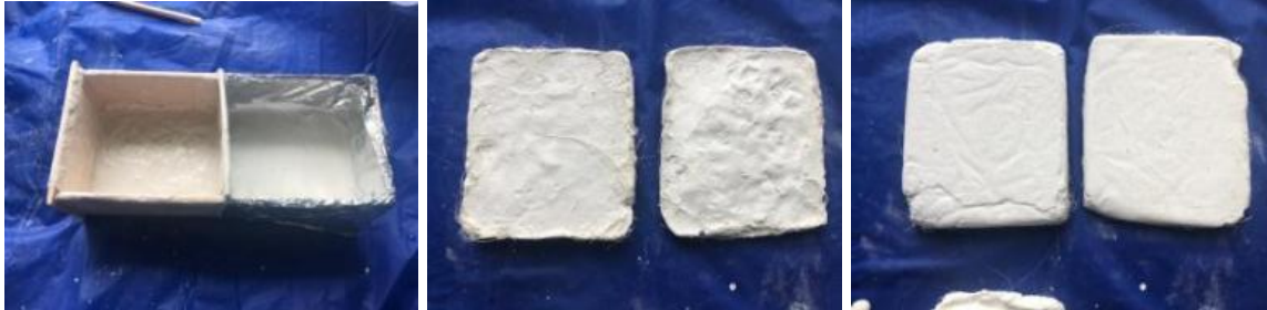
Figura 32 Experimentación de encolados naturales con fibras de cabuya con yeso
