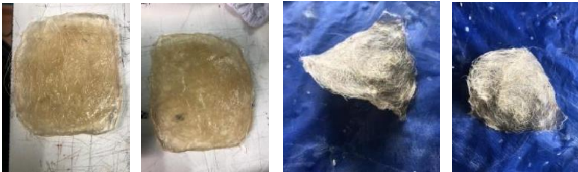
Figura 35 Experimentación de encolados naturales con fibras de cabuya con grenetina semiseco y seco
