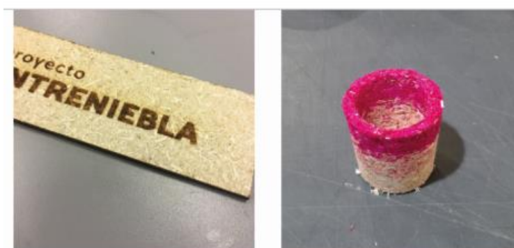
Figura 14 Prueba perforación, grabado láser y teñido de Entreniebla. Tomado de: Martel & Pacheco, 2018
