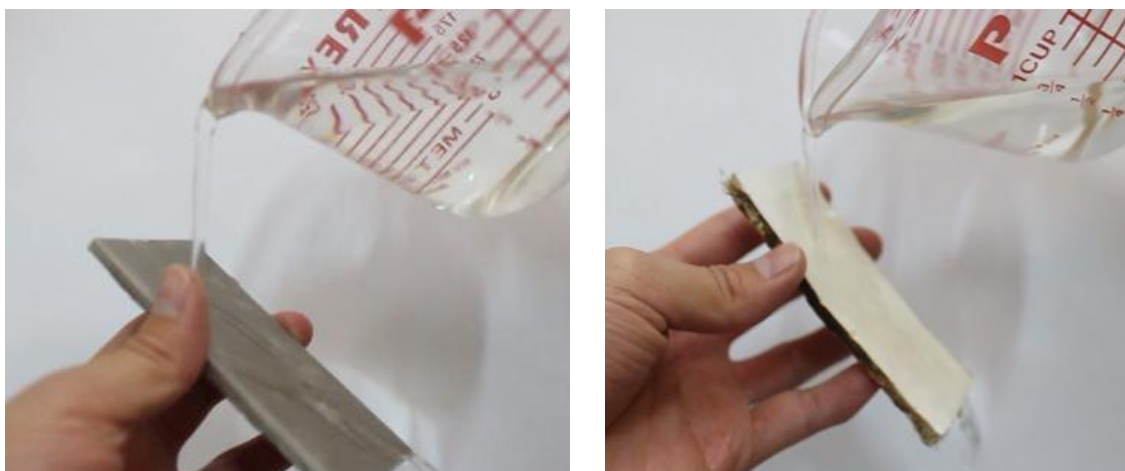
Figura 89 Evidencia fotográfica de la prueba de Impermeabilidad
