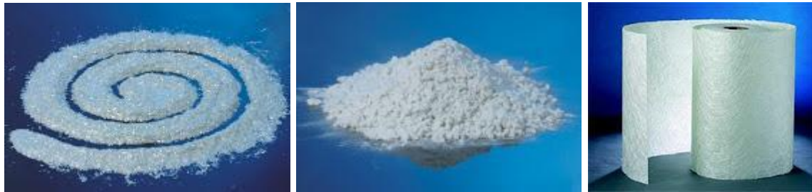
Figura 8 Presentaciones: Hilo cortado, Fibra molida y Mat de hilos cortados. Tomado de: Tecnología de los Plásticos, 2011
