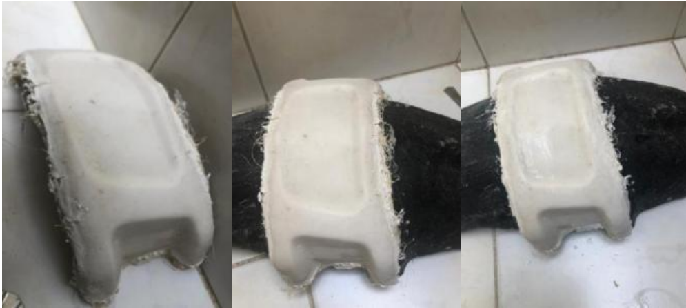
Figura 43 Experimentación con proceso productivo de bioresina y mat de fibras vegetales en molde de moto pieza
