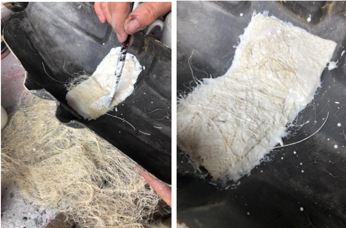
Figura 81 Osito, el experto, aplicando la primera y segunda capa de biomat, durante la validación del material.
