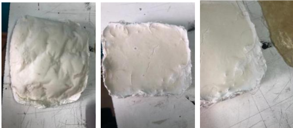
Figura 37 Experimentación de encolados naturales con fibras de cabuya con Fécula de maíz y grenetina semiseco
