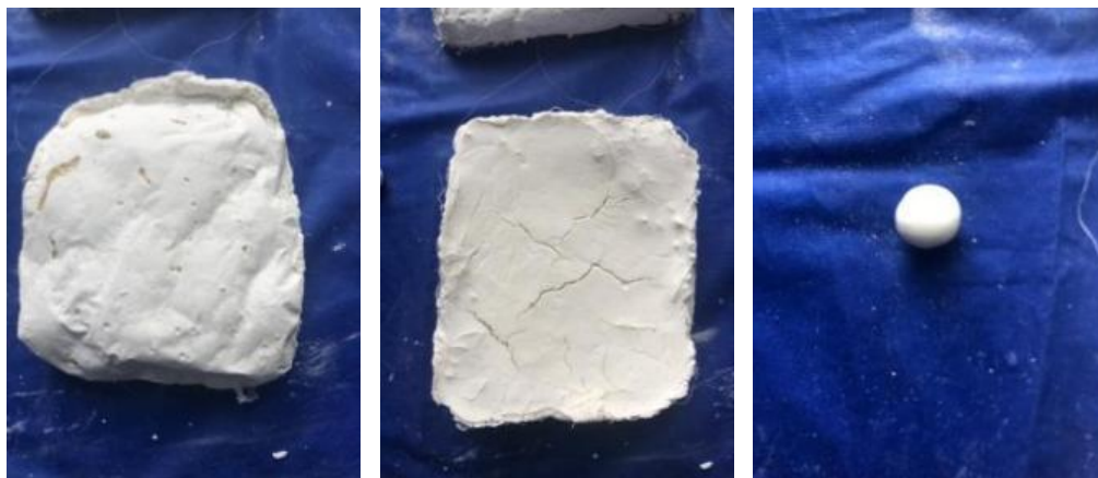
Figura 38 Experimentación de encolados naturales con fibras de cabuya con grenetina y fécula de maíz seco.
