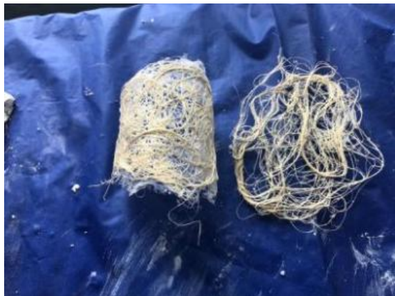
Figura 27 Experimentación de tratamiento de fibras de cabuya con encolado de goma blanca
