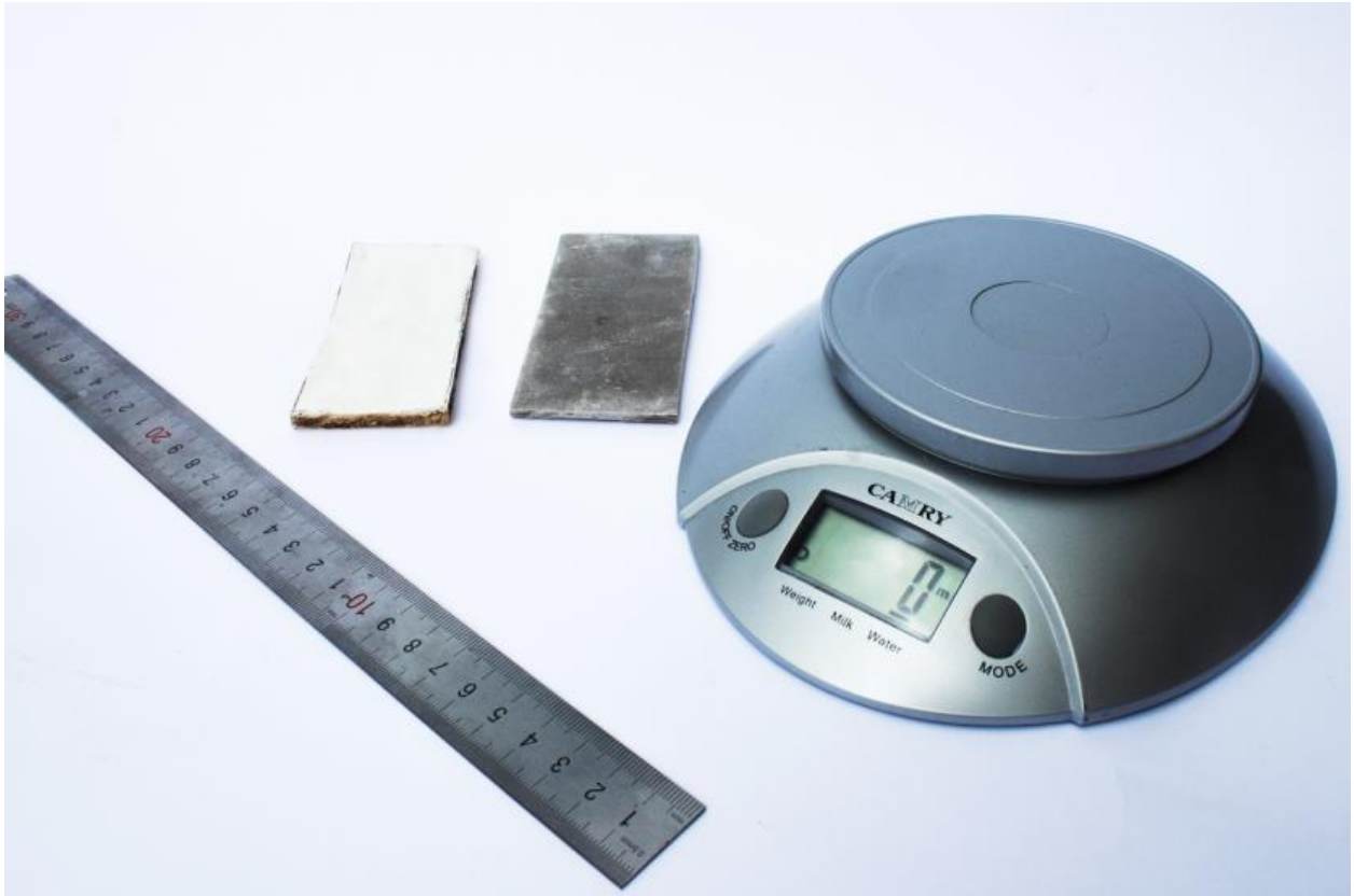
Figura 83 Herramientas utilizadas para medir la uniformidad de peso
