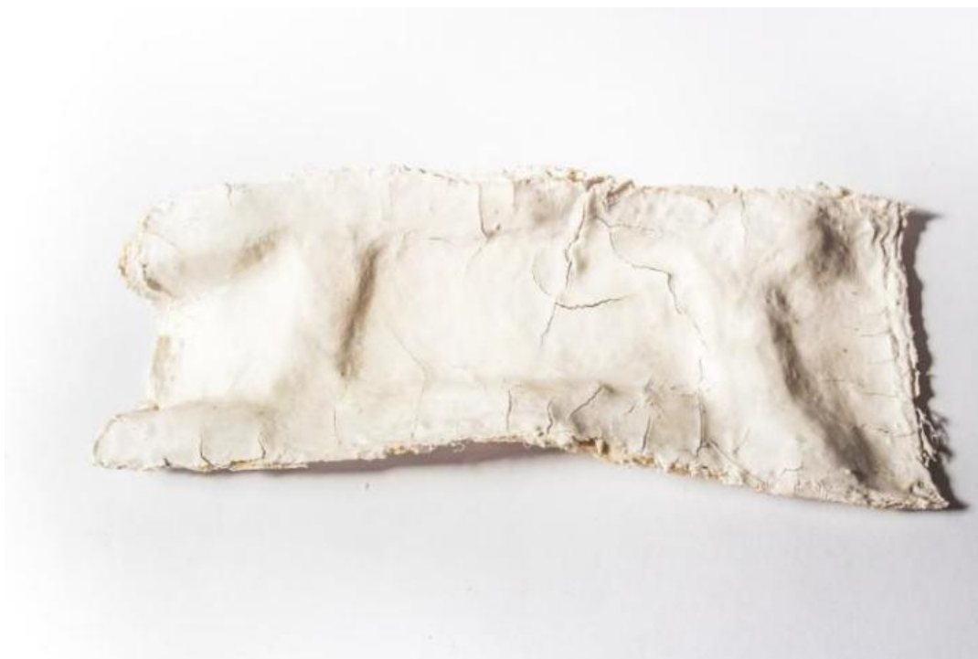
Figura 44 Resultado experimentación proceso productivo de bioresina y mat de fibras vegetales en molde de motopieza seca
