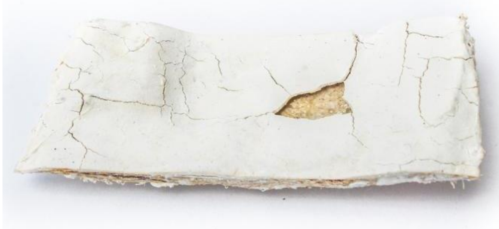
Figura 51 tercera experimentacion de acabados, intento de corregir la pieza con bioresina
