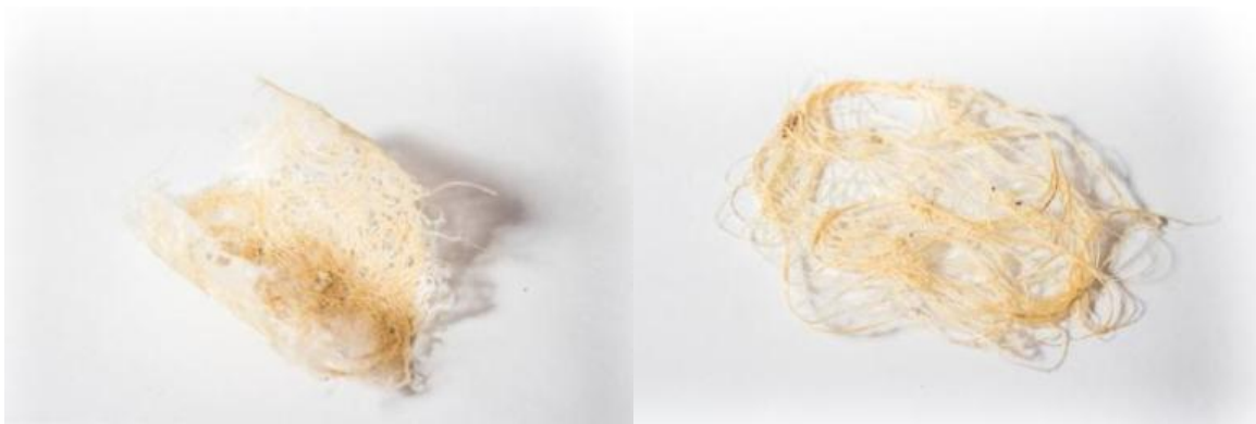
Figura 29 Resultado final de tratamiento de fibras de cabuya y encolado natural. con deformación y sin deformación
