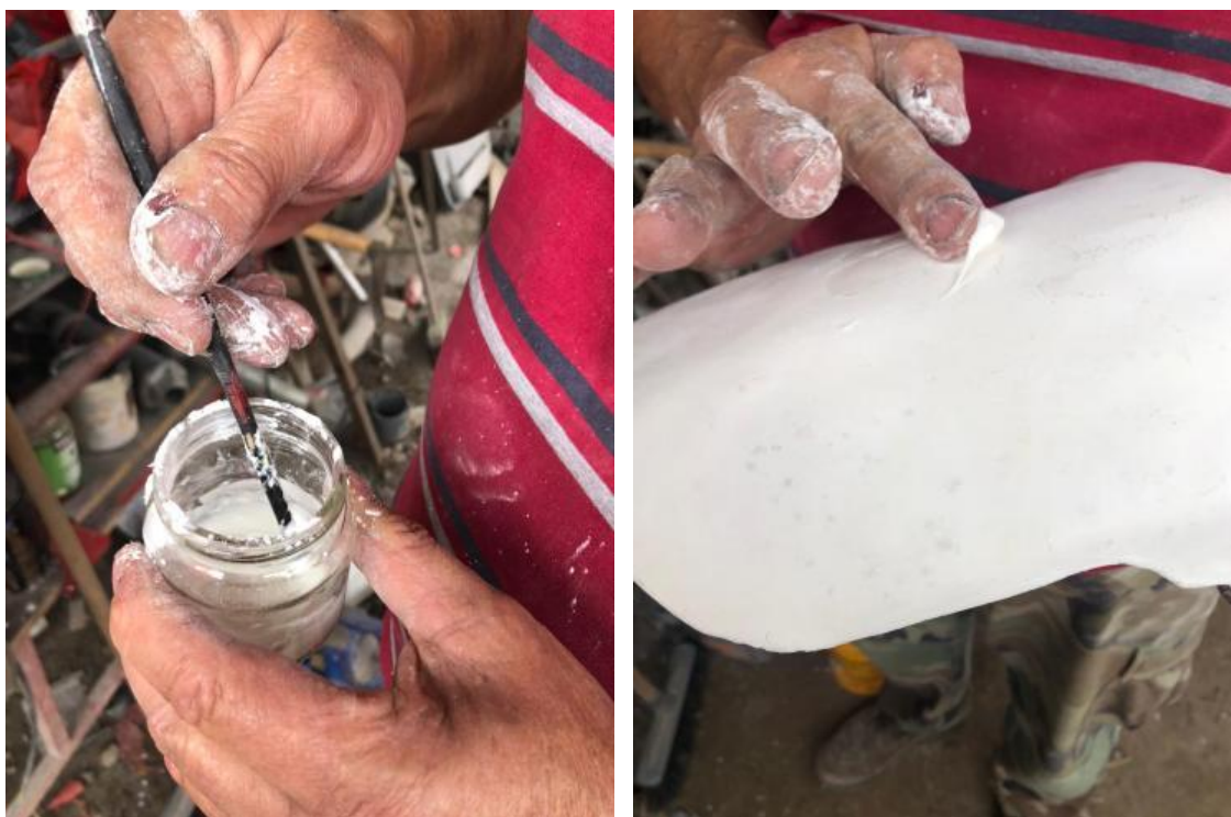
Figura 64 Biomasilla de fécula, cola blanca y grenetina para corregir imperfecciones de la biopieza
