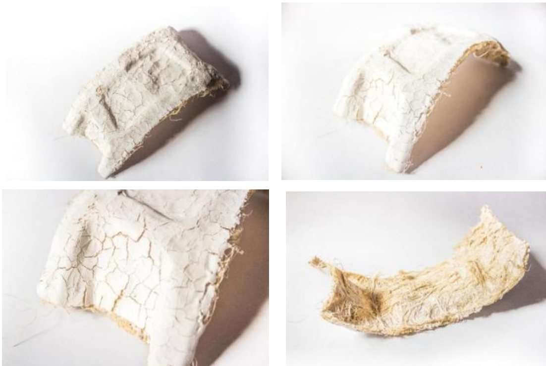
Figura 48 Resultado experimentación segundo proceso productivo de bioresina y mat de fibras vegetales en molde de motopieza seca, varias perspectivas
