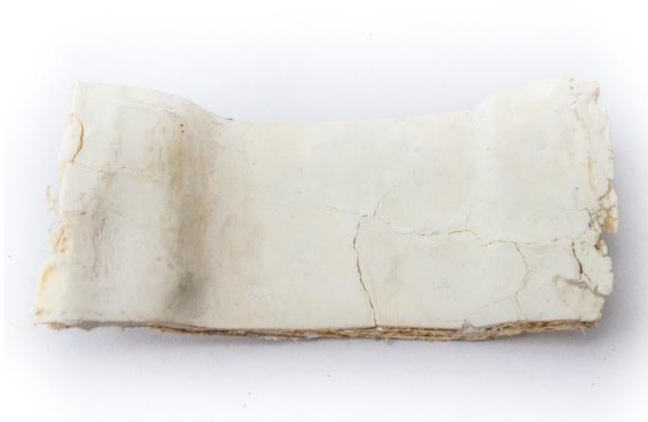
Figura 50 Segunda experimentación de acabados, pieza masillada y lijada
