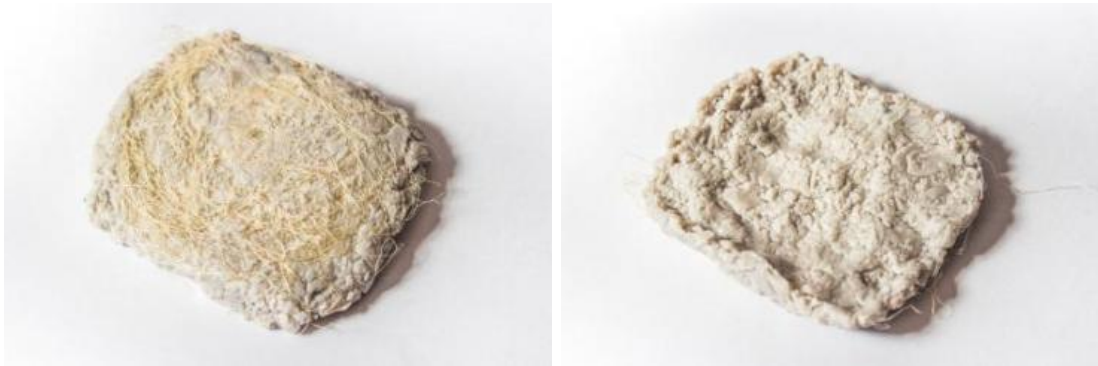
Figura 41 Resultado de la Experimentación de encolados naturales con fibras de cabuya con yeso y cera
