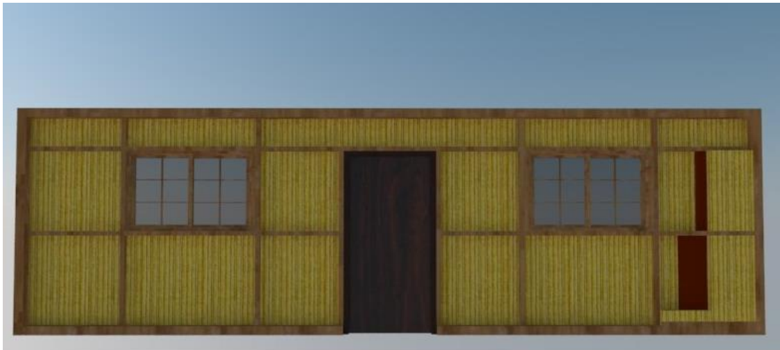
Vista de la pared interior de una vivienda construida en caña guadua
