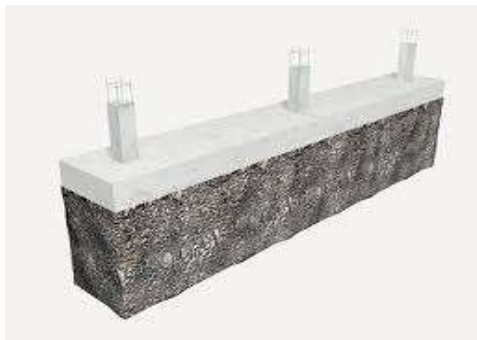
Figura 3 Zapata corrida Tomado de (CONSTRUCCIONES, s.f.)
