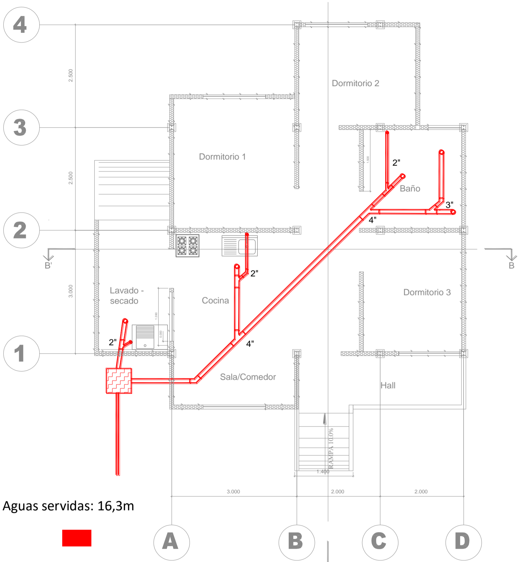
Figura 5b Aguas servidas vista en planta
