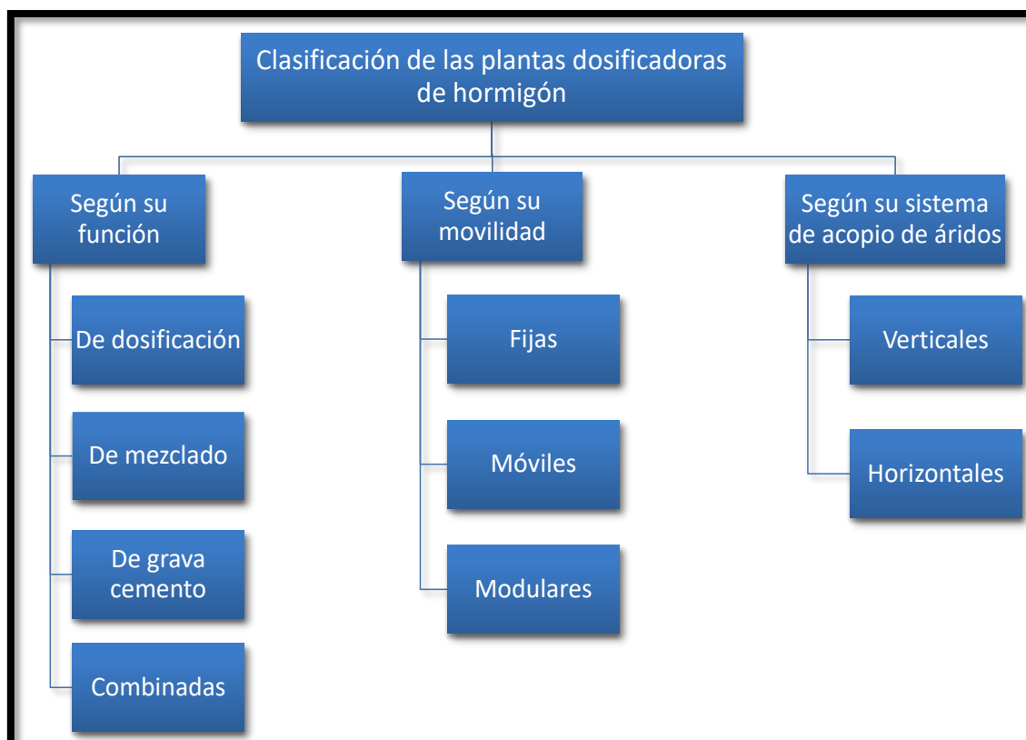
Figura 3: Clasificación de las plantas dosificadoras de hormigón
