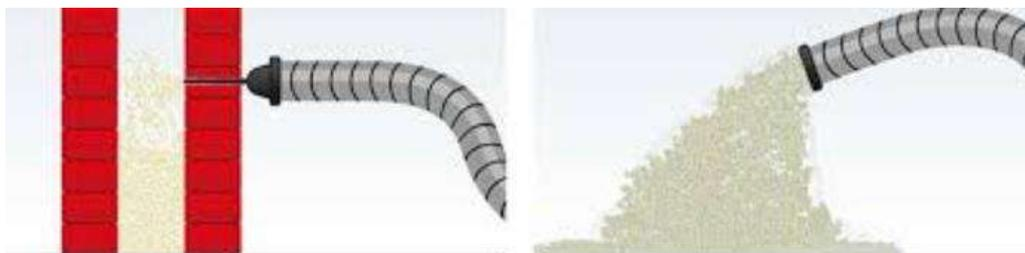
*Figura 28.* Aislamiento insuflado y aislamiento soplado.
