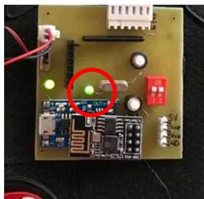
*Figura 55. Led indicador de activación de sensor*
