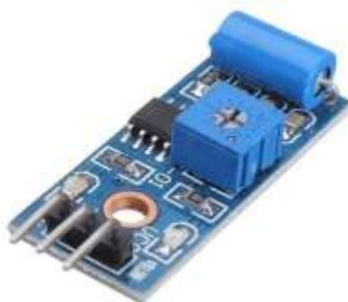
Figura 14. Sensor de vibración con comparador incluido
