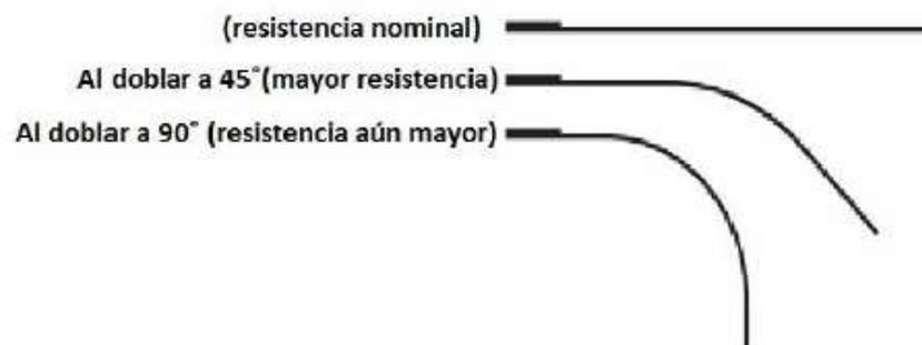
*Figura 11. Valor de resistencia acorde al ángulo de curvatura*
