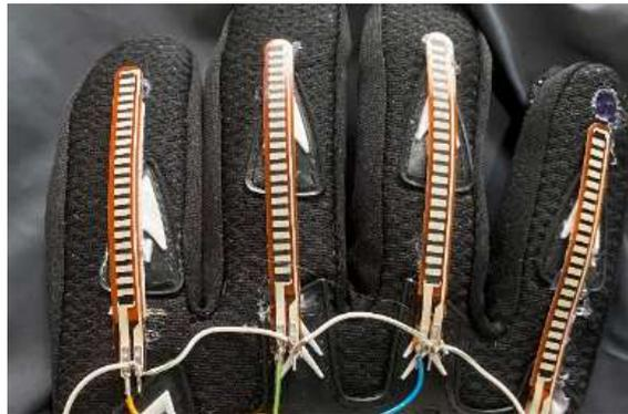
*Figura 49. Sujeción de los sensores y caja contenedora*
