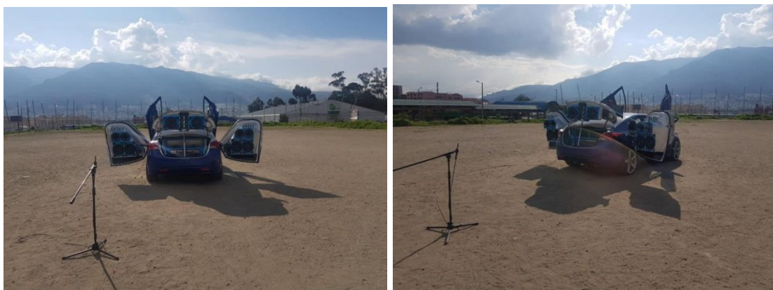
Figura 81. Colocación del micrófono de medición hacia el sistema sonoro
