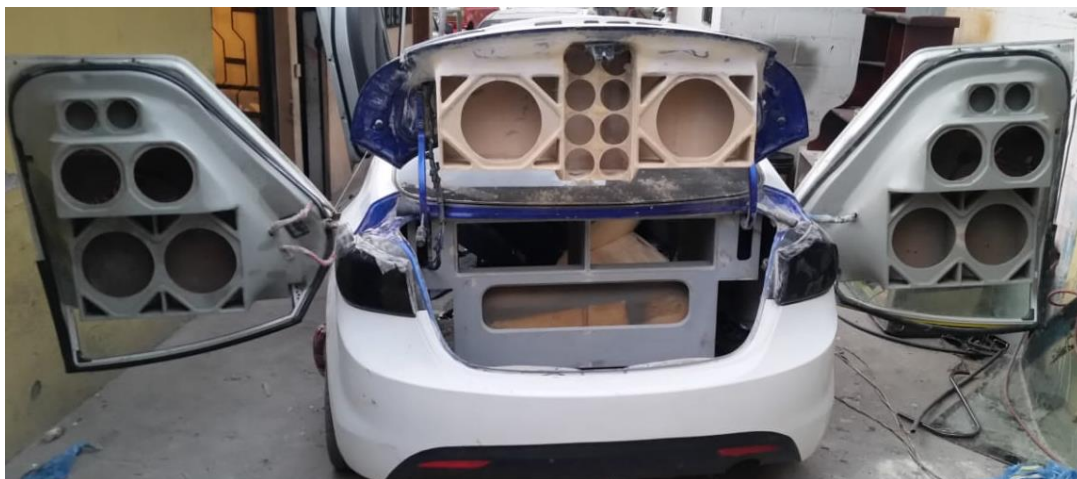
Figura 68. Montaje del sistema de Cajas Acústicas
