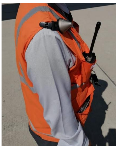
Figura 27. Dosímetro colocado en el personal de mantenimiento.
