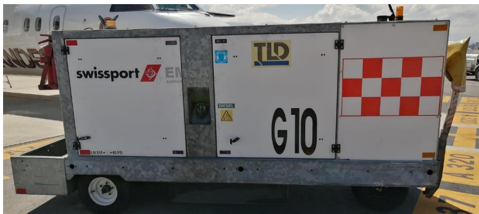
Figura 16. Unidad de fuente de energía TLD GPU 4090 CUP 28V.
