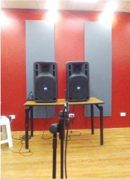
Figura 13. Medición de los espectrogramas de las canciones con el micrófono Beyerdynamic MM1 y las cajas RCF ART 315A
