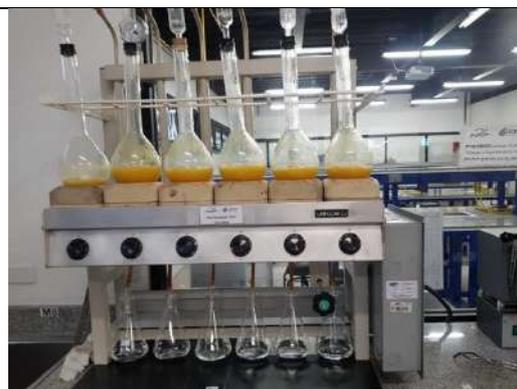
Verificar que no gotee para subir la temperatura a 78°C, ya que en dicha temperatura se empezará a evaporar el alcohol obtenido del fermento.
