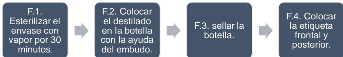
Figura 10. Diagrama de Flujo embotellado y etiquetado.
