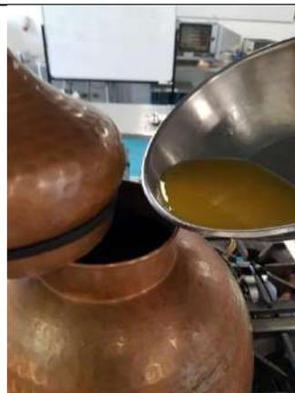
Mantener a una temperatura de 65°C para poder retirar el metanol, al momento que deje de gotear el alambique, significa que ya se evaporó todo el metanol del fermento.
