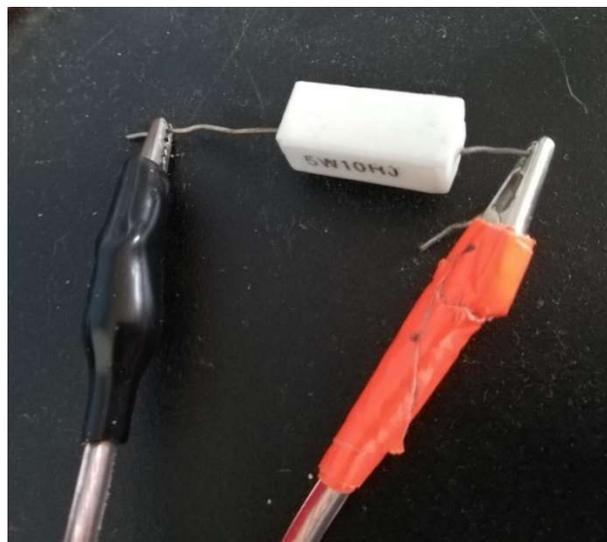
Figura 22. Resistencia de calibración.
