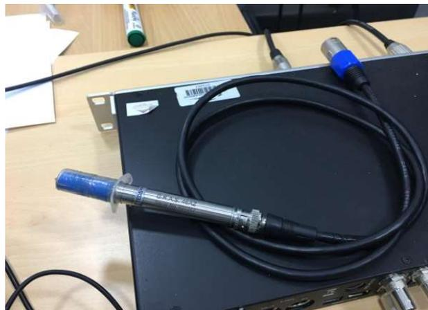
*Figura 41.* Adaptación de jeringa al micrófono de medición conectado a la interface FireFace.
