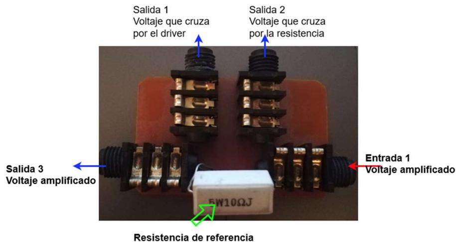
Figura 15. Placa de conexión.
