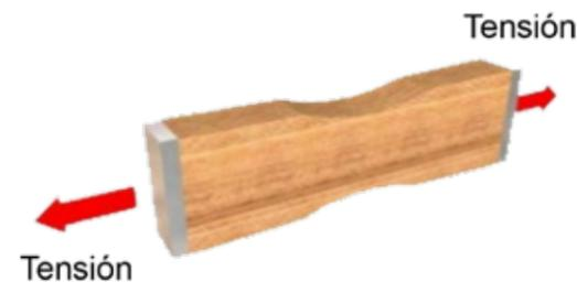
Figura 82. Tracción de madera estructural. Adaptada de UNAM, s.f.
