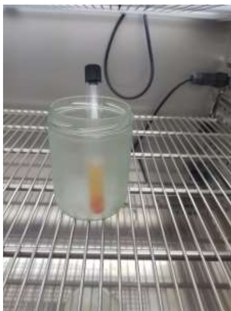
Figura 30. Tubo de ensayo con esferas y líquido de gobierno en la cámara de estabilidad.
