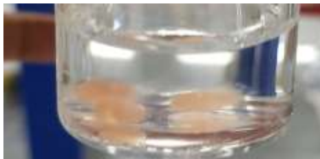
Figura 26. Deformación de esferas por falta de viscosidad.
