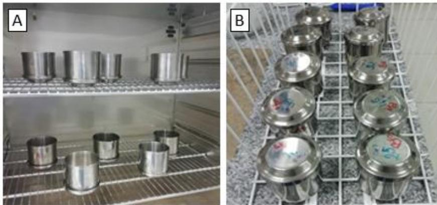
*Figura 5.* Metodología de estufa (A. Cápsulas abiertas en la estufa. B. Cápsulas cerradas previo a ser pesadas)
