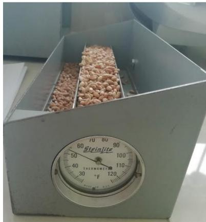
*Figura 8.* Equipo eléctrico Steinlite con muestra de trigo.
