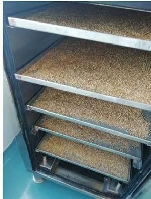
*Figura 3.* Equipo para secar las muestras de trigo (deshidratador Proingel modelo 0A)
