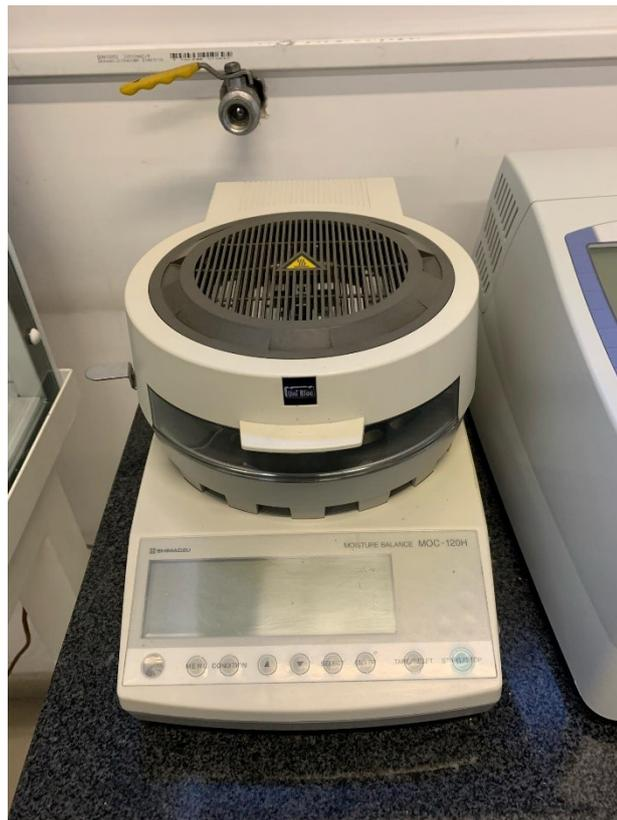
*Figura 4.* Analizador de humedad.
